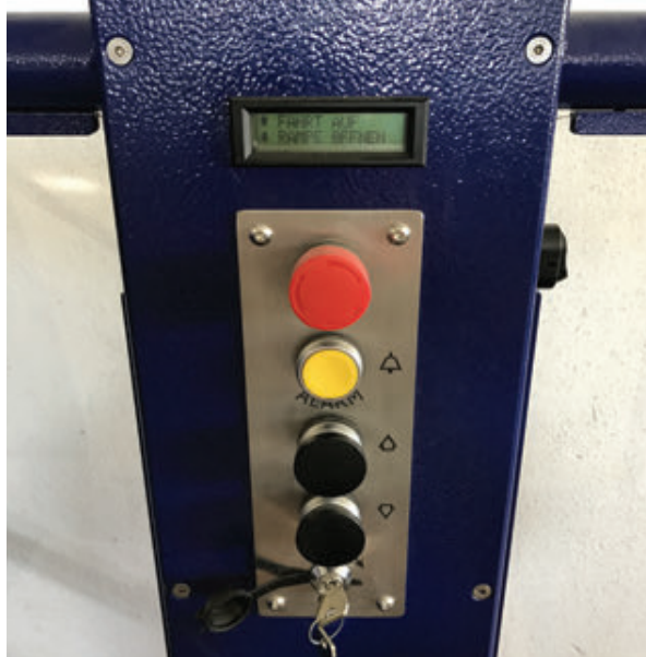
Besturing op het platform met stop en alarm knop, alsmede een display voor fout en status melding
