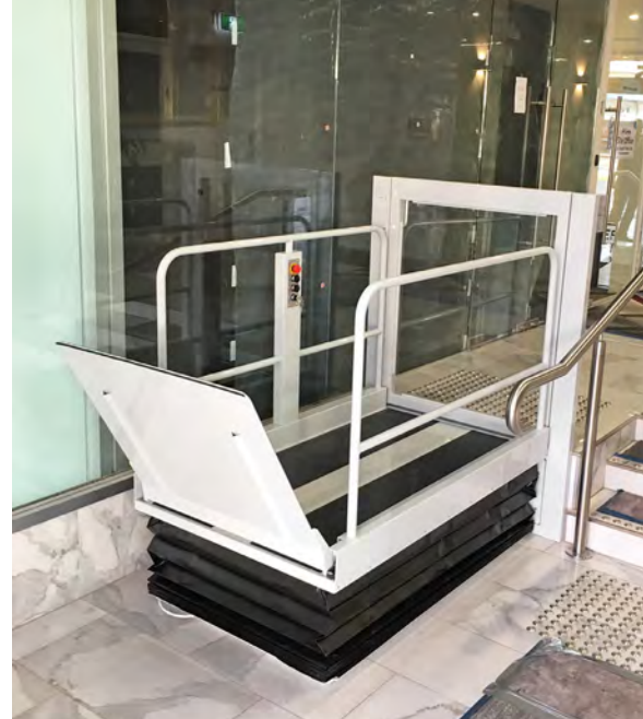
Uitvoering met deur op het bovenste niveau, hoge veiligheidshekken en bedieningszuil.
